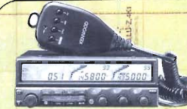
TM 742 E - Veicolare multibanda 144 e 430 MHz più una terza (28-50MHz-1,2 GHz)
