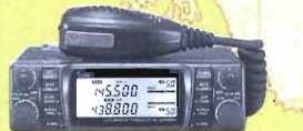
IC 2340 H - Veicolare bibanda VHF/UHF Tx: 144/146 - 430/440 MHz Rx: 118/136 (AM) - 136/174 MHz 320/479 - 830/950 MHz (con modifica)
