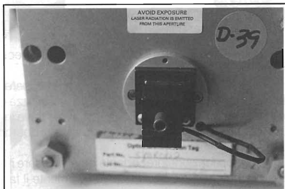
Foto 3 - Particolare dello specchio anteriore con bulloni di allineamento e prisma a foteolemento per feedback ottico power controller.
